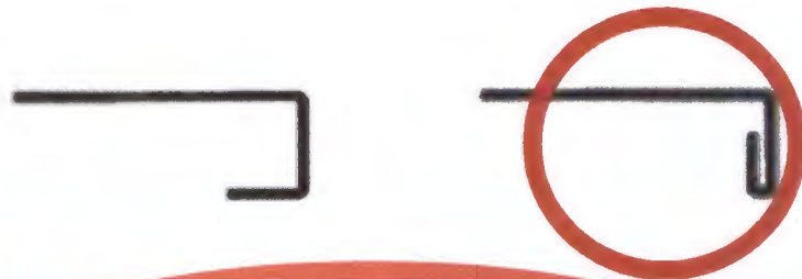
b) Double edge fold stiffeners
