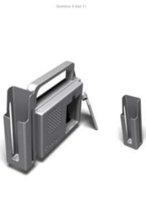
Gambar 4 : Tampak Perspektif Samping Atas Unit Meter dan Dudukan Sensor
