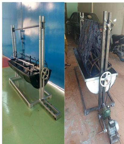
GAMBAR 3 MESIN PEWARNA KAIN UNTUK PEMBUATAN BATIK TULIS YANG SUDAH JADI
