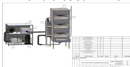
Gambar 2. Desain 3 dimensi prototipe alat pengering kopi berbasis sistem refrigerasi
