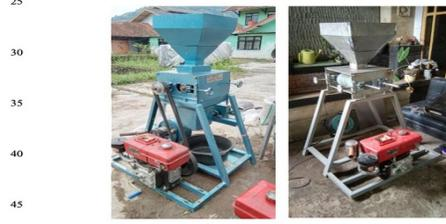
Gambar 2. Mesin Pengupas Kulit Biji Soprgum
