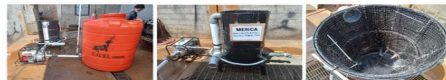
Gambar 1, adalah gambar pandangan perspektif dari MERICA (Mesin Rotasi, Inovatif, dan Cuci Angkat Lada) sesuai dengan invensi ini.
