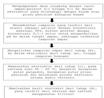
Gambar 1. "Diagram alir proses ekstraksi linamarin"
