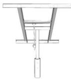
Gambar 2. Tampak bawah dari alat penyangga panel surya yang dapat diatur sudut kemiringannya
