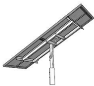
Gambar 5. Tampak perspektif dari dari alat penyangga panel surya yang dapat diatur sudut kemiringannya
