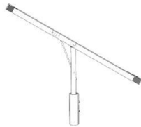
Gambar 4. Tampak samping kiri dari alat penyangga panel surya yang dapat diatur sudut kemiringannya
