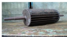
Gambar 2. Runner turbin cross-flow telah selesai dirakit
