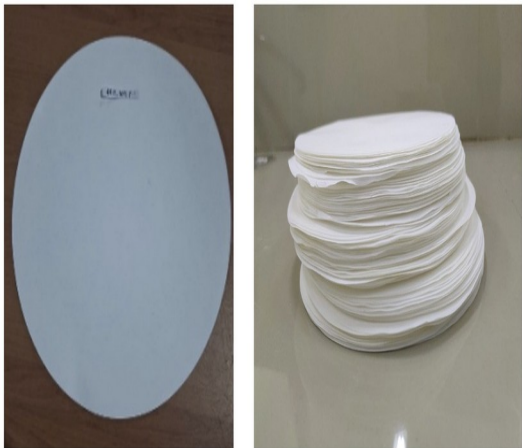
Handsheets 80 gsm dari pulp kenaf yang diputihkan dengan metode TCF
