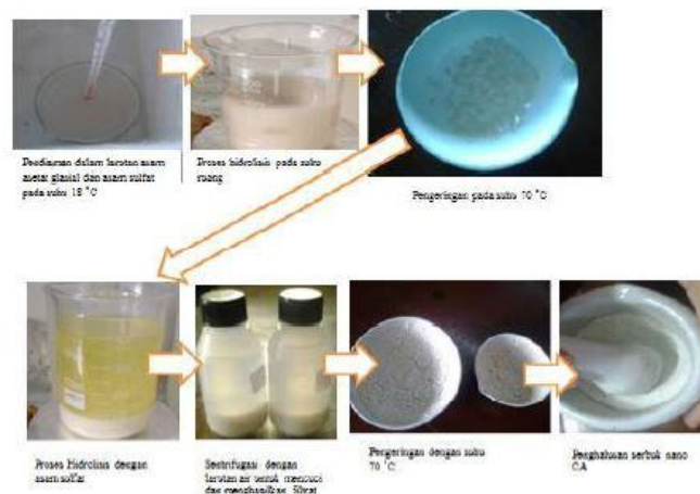
Gambar 1. Prosedur Sintesis Selulosa Asetat
