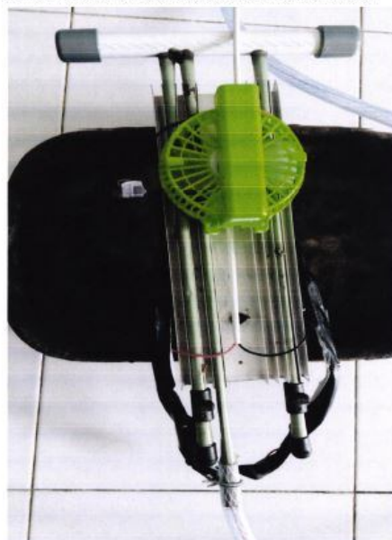
Gambar 1.struktur thermoelektrik (konversi panas dengan dingin)
